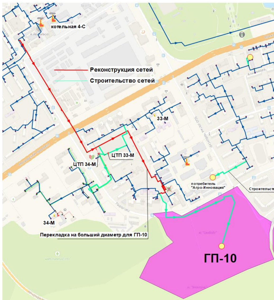
Рисунок 3 – Строительство и перекладка участков на больший диаметр с целью обеспечения теплоснабжением переключаемых котельных 33,34-М на 4-С (Вывод I).
