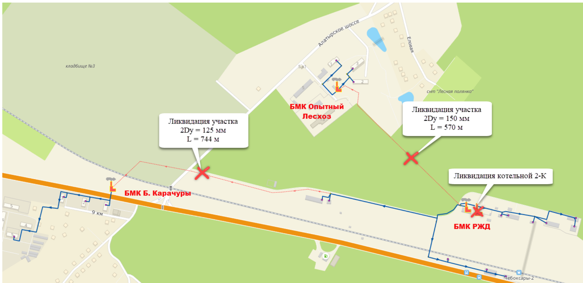
Рисунок 1 – Перевод тепловой нагрузки с котельной 2-К на БМК Б. Карачуры, БМК Опытный Лесхоз и БМК РЖД
