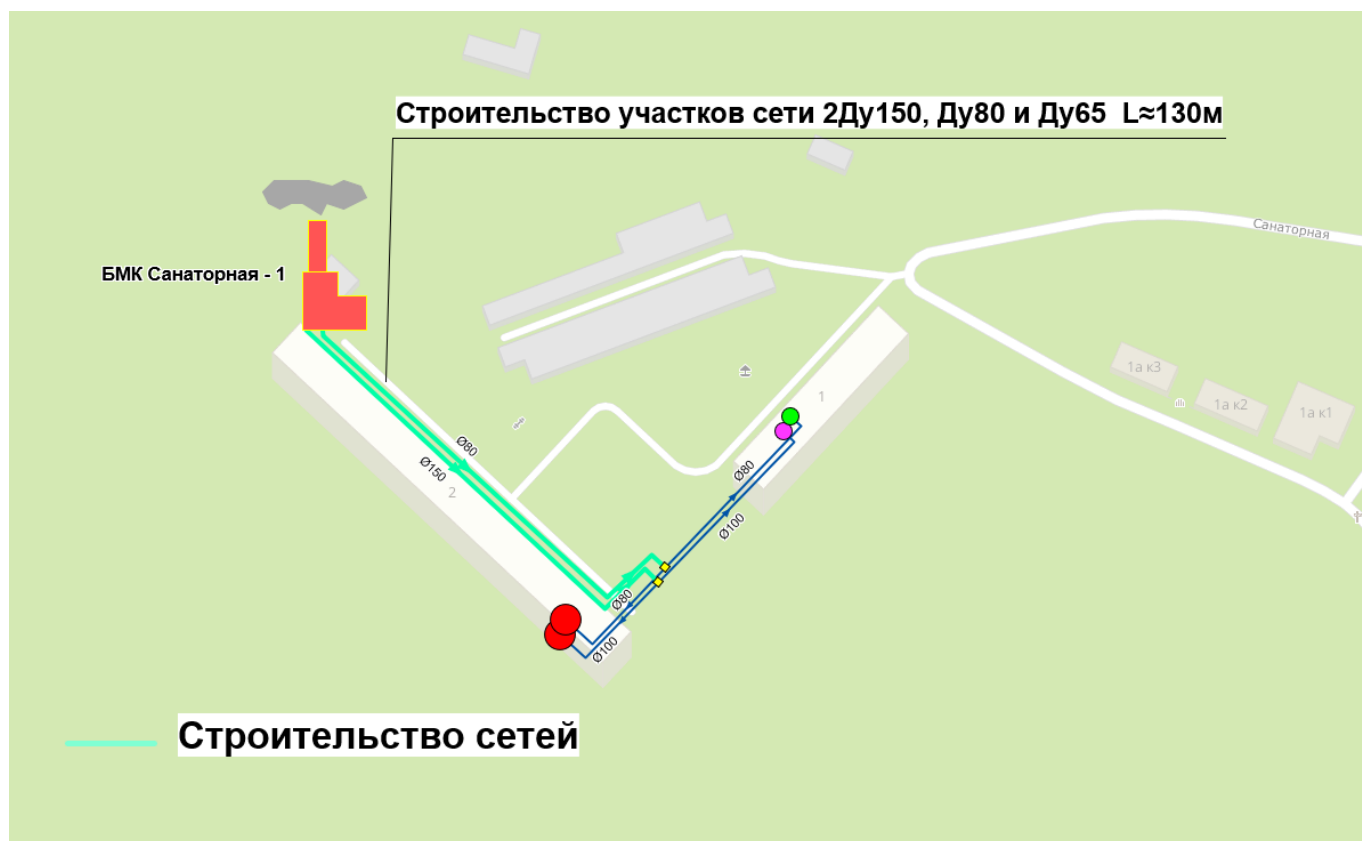
Рисунок 9 – Строительство тепловых сетей с целью переключения сторонних потребителей котельной Санаторий «Чувашия» на новую БМК Санаторная - 1
