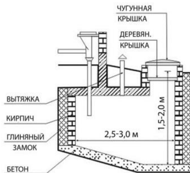
Рис. 1.1. Схема устройства выгребной ямы из бетона
