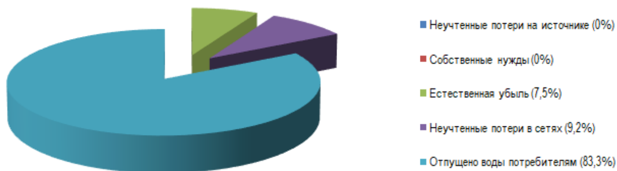
Рис. 3.3. Распределение затрат поднятой воды в пределах Восходского ТО
