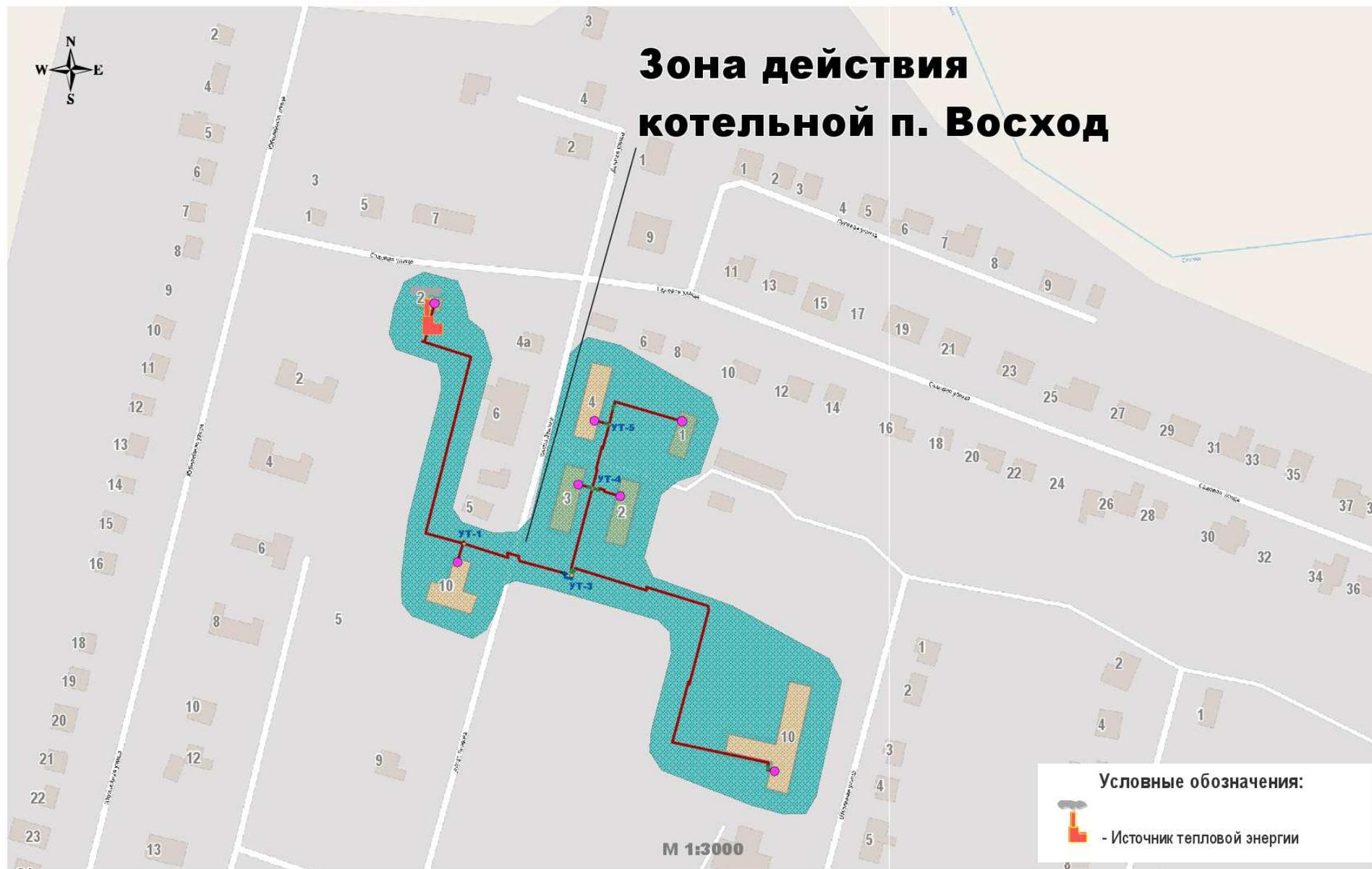
Рис. 2.1. Существующая зона действия системы теплоснабжения и централизованного источника тепловой энергии – котельной п. Восход.
