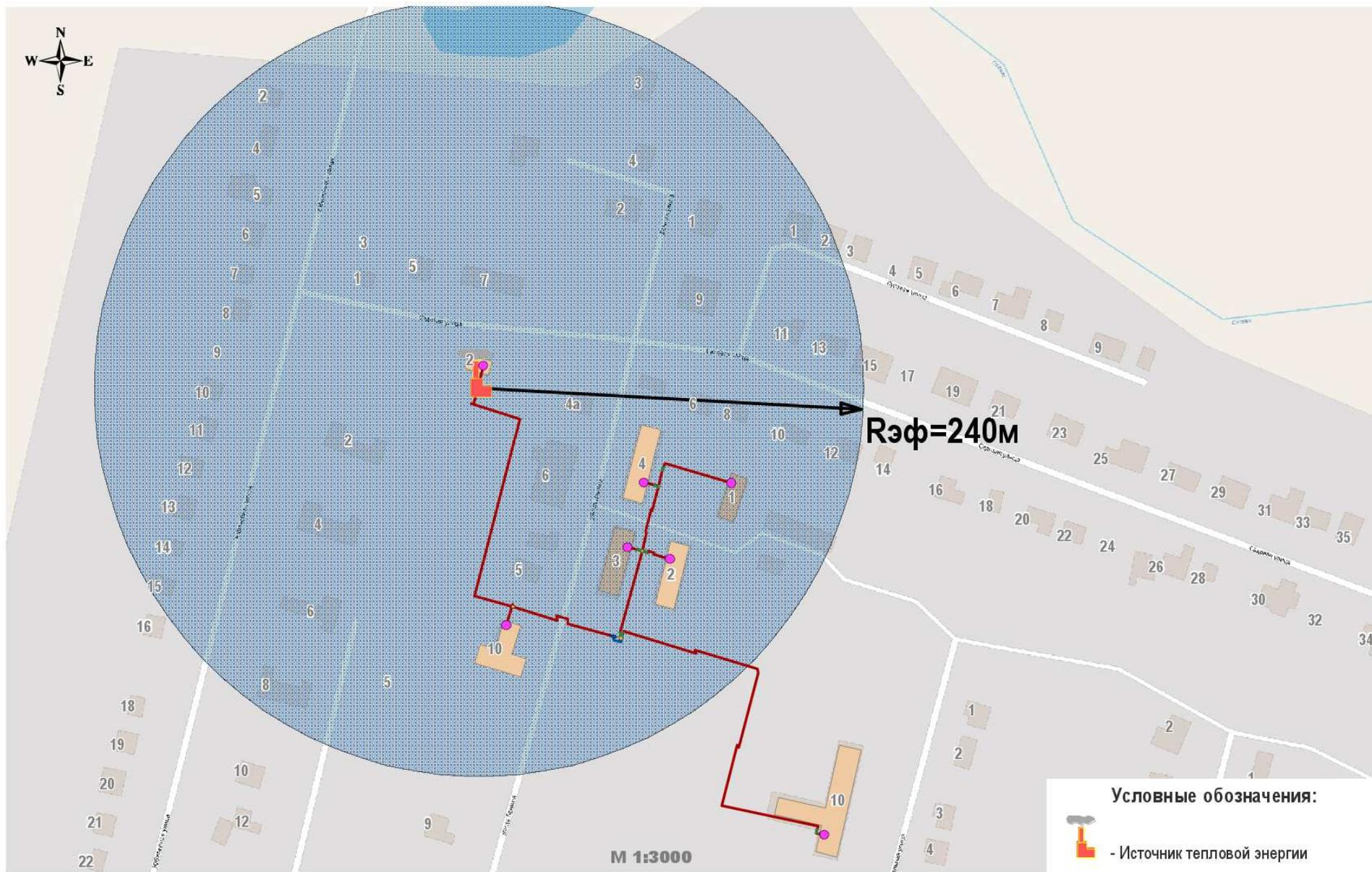
Рис. 2.3. Схема существующего радиуса эффективного теплоснабжения от котельной п. Восход.
