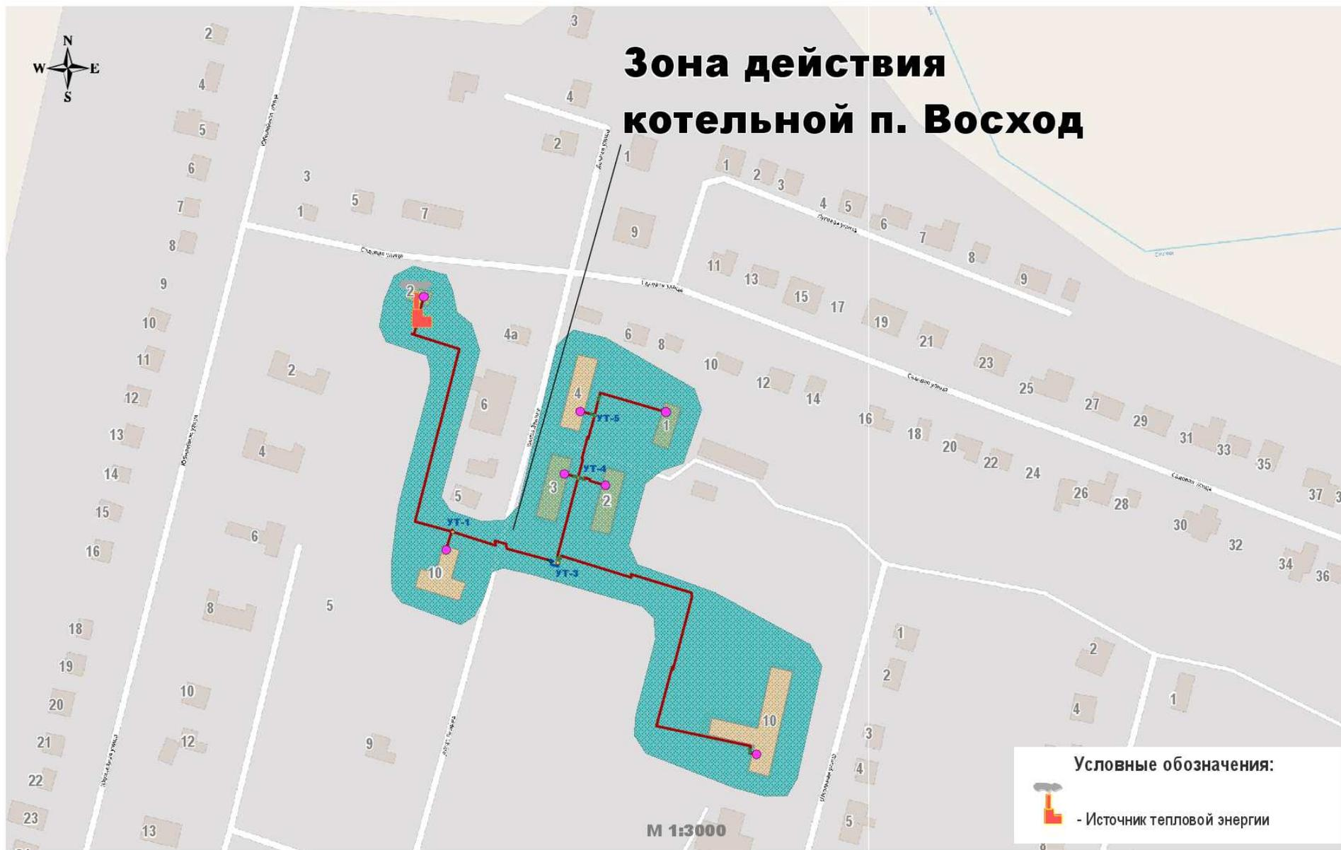
Рис. 2.2. Перспективная зона действия системы теплоснабжения и централизованного источника тепловой энергии – котельная п. Восход.
