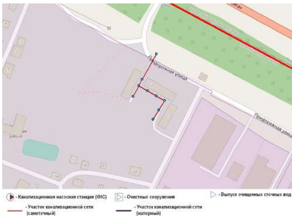
Рисунок 19 – Расположение сетей д.Сятракасы от МЖД по ул.Восточная
