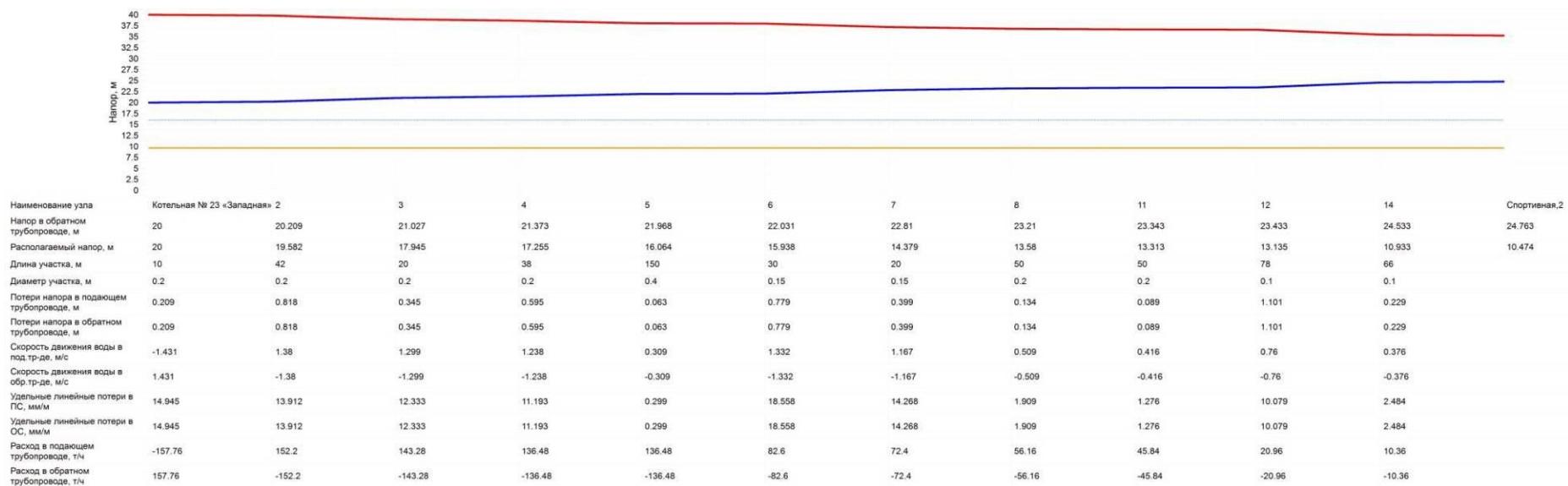
Рисунок 1.3.29 – Пьезометрический график тепловых сетей котельной №23 «Западная»
