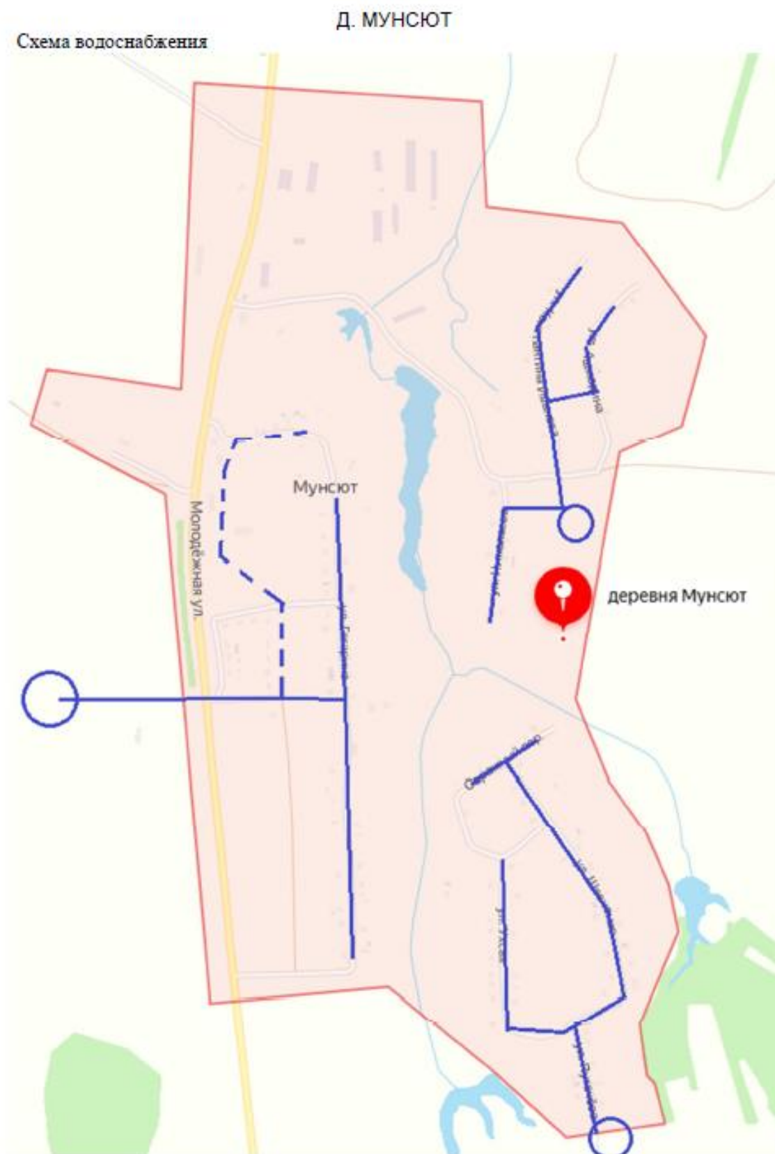
рис. 1.4.40. Расположение скважины и сетей д.Мунсют
