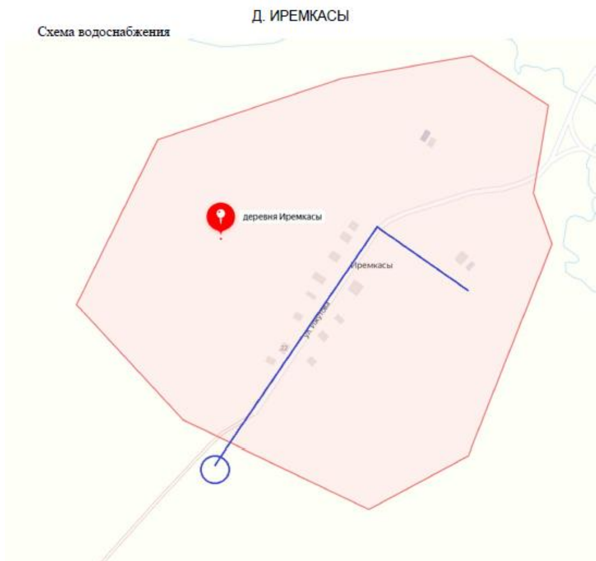
рис. 1.4.77. Расположение скважины и сетей д.Иремкасы
