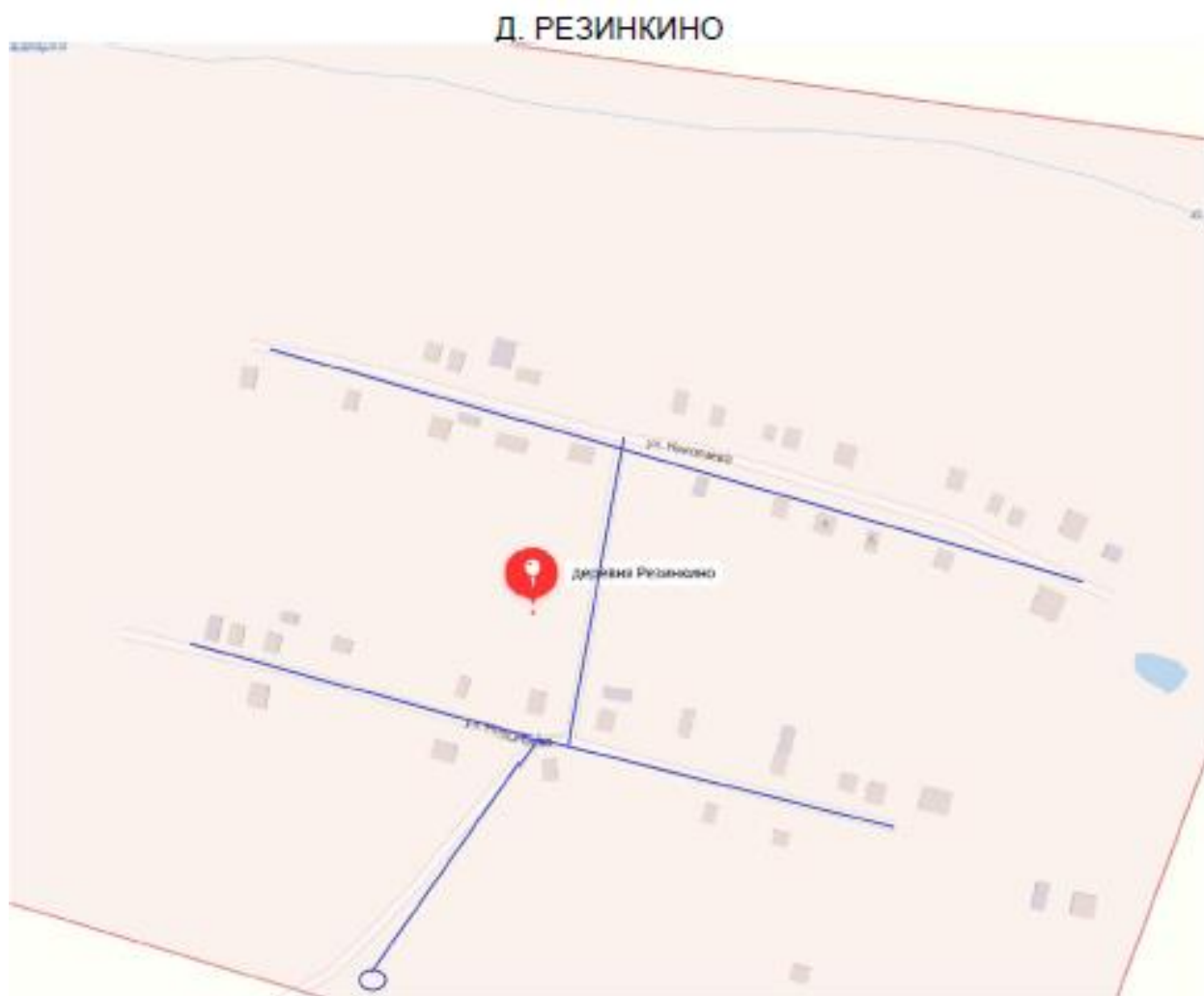
рис. 1.4.35. Расположение скважины и сетей д.Резинкино
