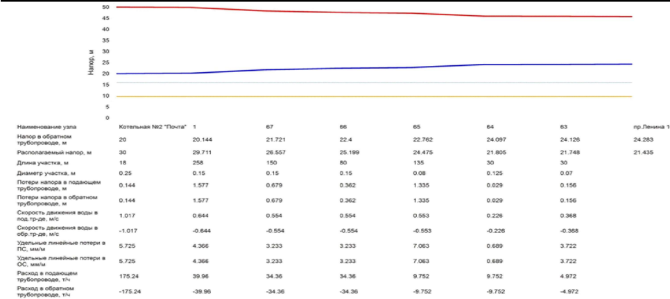
Рисунок 3.52 - Пьезометрический график тепловых сетей котельной №2 "Почта"
