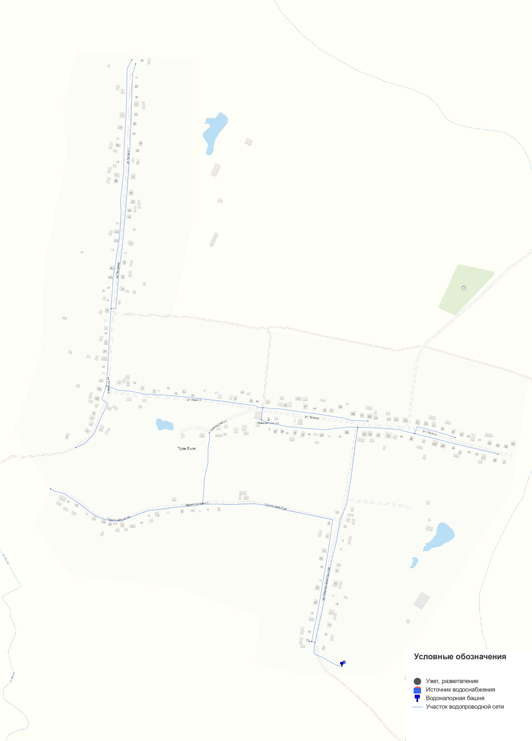
Приложение 18 - Схема сетей водоснабжения д. Тури-Выла
