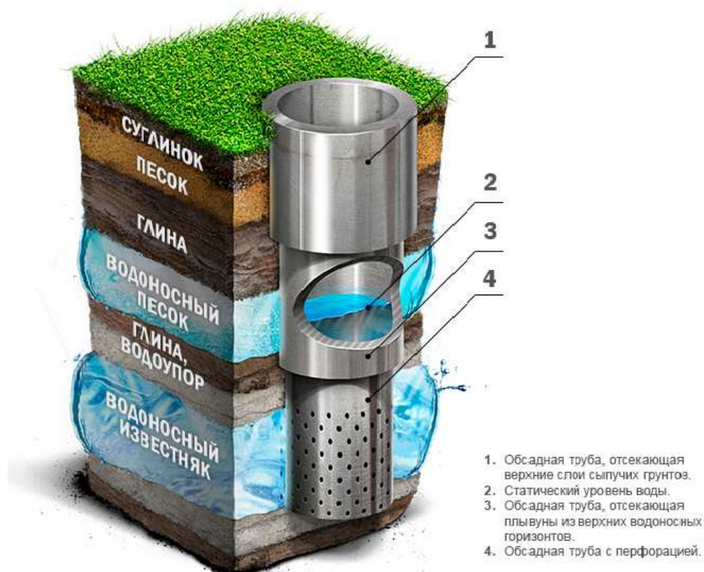
Рис. 4.1. Конструкция артезианской скважины
