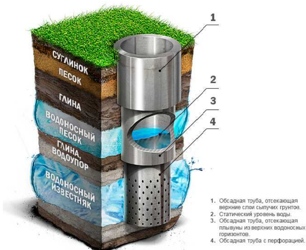
Рис. 4.1. Конструкция артезианской скважины
