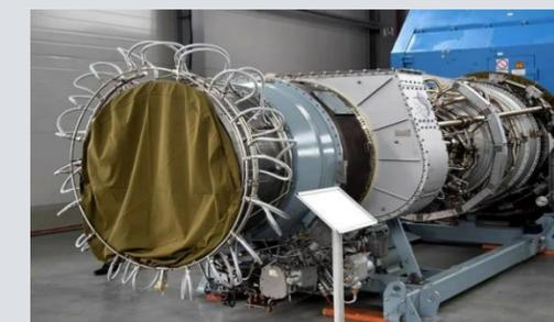
Газотурбинные установки морского исполнения двухтопливные от 7,5 МВт
