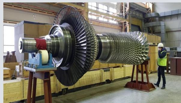
Создание производства газовых турбин большой мощности
