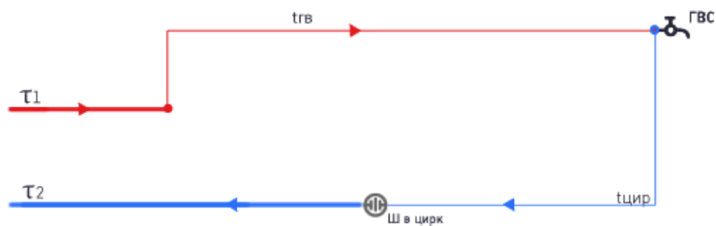
Рис. 1.3.16.2 Схема присоединения системы горячего водоснабжения потребителей по четырехтрубной схеме теплоснабжения.
