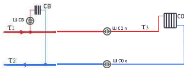
Рис. 1.3.16.1 Схема непосредственного присоединения к тепловым сетям системы отопления потребителей.
