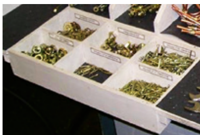
Размещение мелких предметов в ячейках. Наименование хранимых деталей одновременно является указанием на максимальный уровень их хранения.
