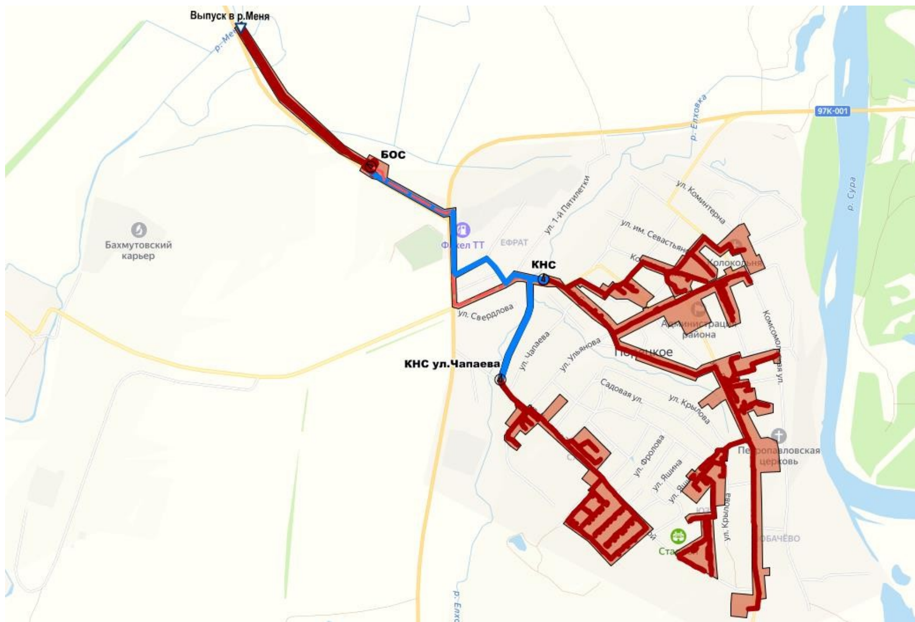
Рис. 2.1.3.1 – Зона централизованного водоотведения с.Порецкое
