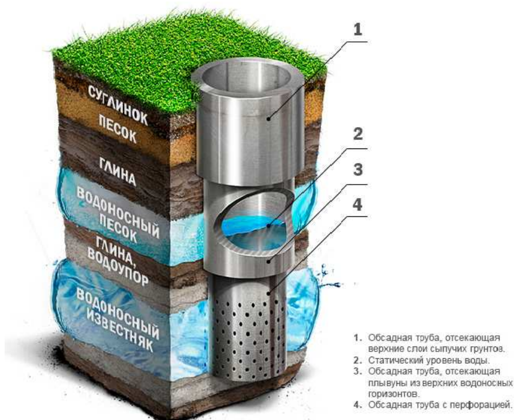
Рис. 4.1. Конструкция артезианской скважины
