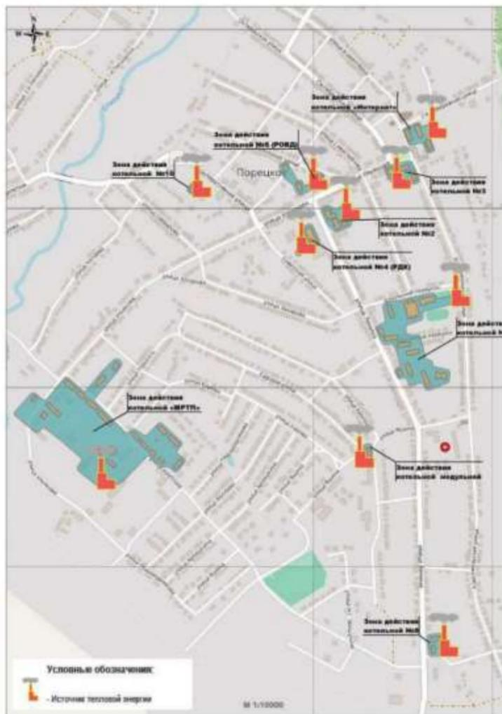
Рис. 2.2. Перспективные зоны действия систем теплоснабжения и централизованных источников тепловой энергии – котельных Поречского муниципального округа.
