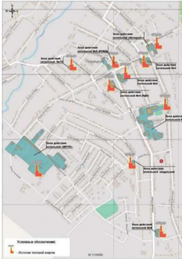
Рис. 2.1. Существующие зоны действия систем теплоснабжения и централизованных источников тепловой энергии – котельных Поречского муниципального округа.
