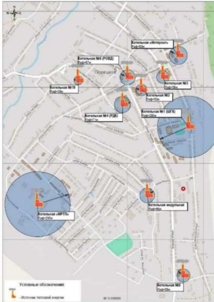
Рис. 2.3. Схема существующих радиусов эффективного теплоснабжения от централизованных источников тепловой энергии Поречского муниципального округа.
